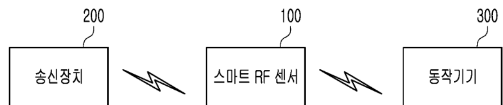
<스마트 RF 센서 이용한 공연시스템 개략 구성>
